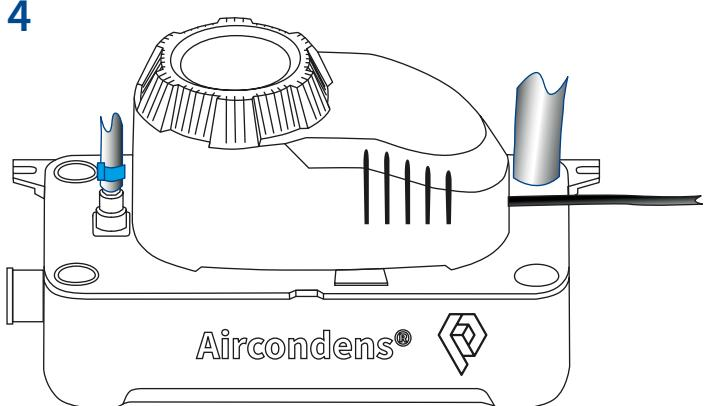
**IT** 1 Scegliere un luogo di installazione adeguato alle dimensioni dell'unità e all'accessibilità dei collegamenti. Collegare la pompa di condensa in posizione orizzontale in un locale asciutto, ben ventilato e protetto dal gelo.
